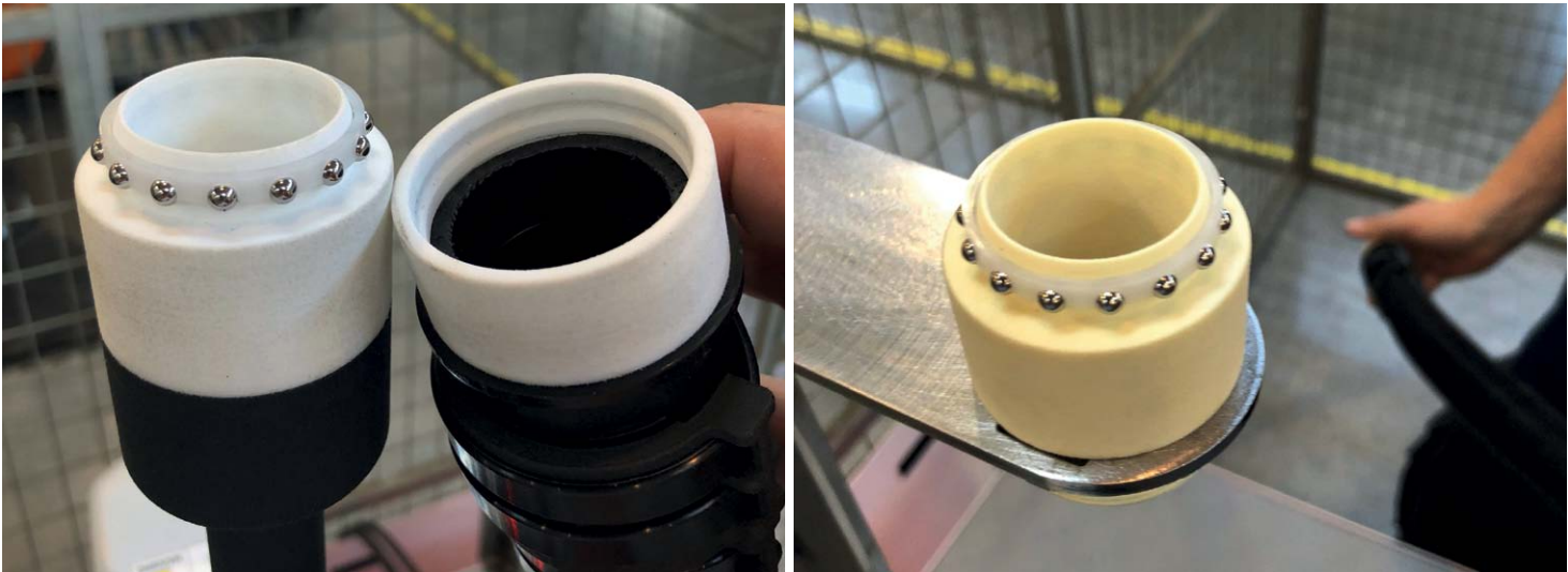
Erste Versuche mit Drehanbindungen aus dem 3D-Drucker: Die Axialkräfte erwiesen sich für die Konstruktion allerdings als zu hoch.
